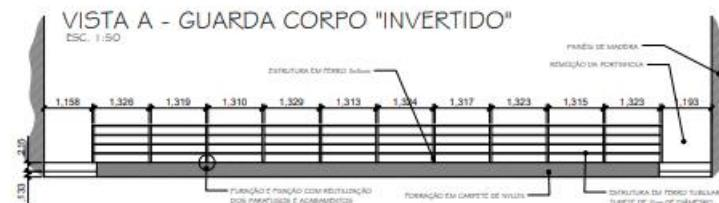
IMPORTANTE: INVERSÃO DO LADO DO GUARDA-CORPO, COM A ESTRUTURA DE TUBETES PARA O LADO DAS CADERAS, AUMENTANDO A BASE DE APOIO DOS VIDROS ( 4cm). VERIFICAR ATRAVÉS DAS MEDIDAS. QUANDO POSSÍVEL UTILIZAR AS MESMAS FURACÕES.
