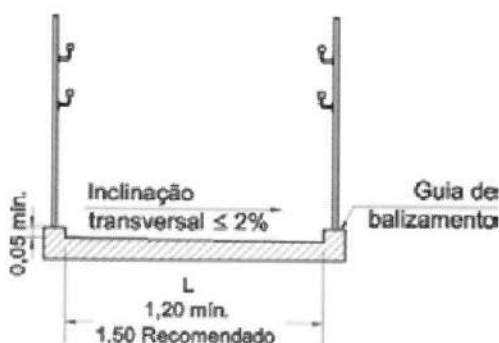
Figura 80 — Inclinação transversal e largura de rampas - Exemplo
