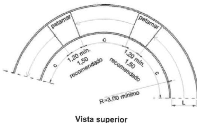
Figura 81 — Rampa em curva - Exemplo
